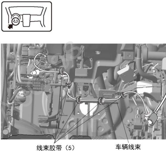
21、拔出车辆 44 极接线器。
