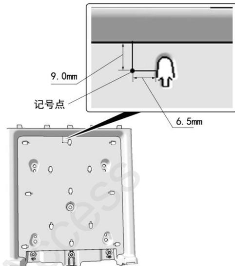
14、根据记号点在中控储物箱底板上开孔。
