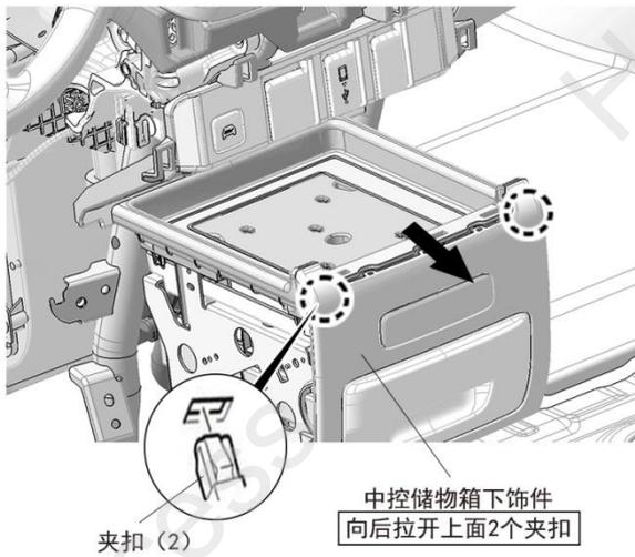
12、拆出中控储物箱底板。
