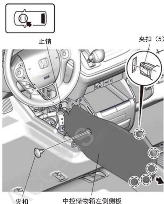
5. 拆出中控储物箱右侧侧板。
