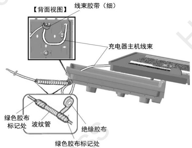
17、复原中控储物箱底板，整理铺放充电器主机线束。
