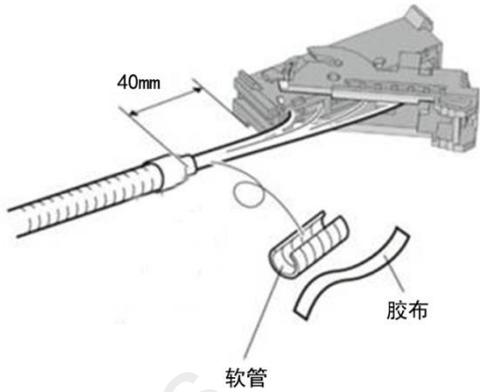
25、连接线束的白色导线与车辆 44 极接线器。
